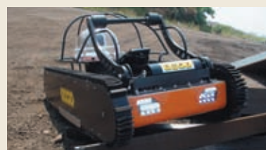
検知型ロボット「X-crawler™ (エクスクローラー)」
