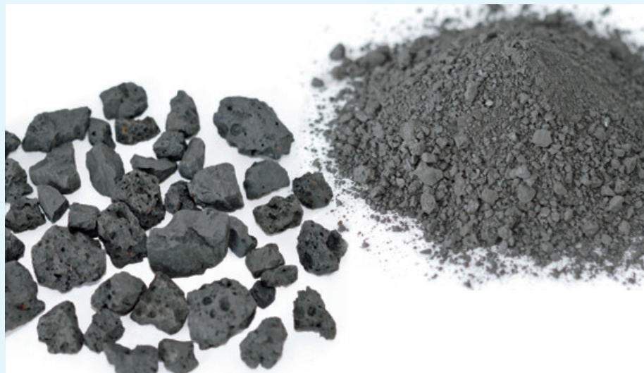
写真：(左) 粗骨材 (粒径5~20ミリメートル)、(右) 細骨材 (粒径5ミリメートル以下)
