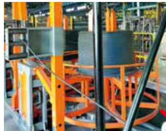
高密度に巻き取ったコンパクトコイルを伸線しNC加工機に投入
