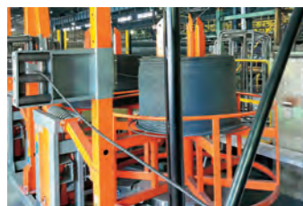
高密度に巻き取ったコンパクトコイルを伸線しNC加工機に投入
