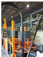
ティーエーコイルを NC 加工機に投入
